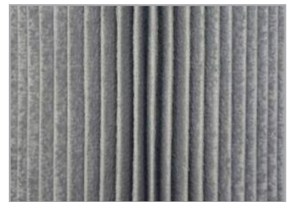
cartouche filtrante après décolmatage
